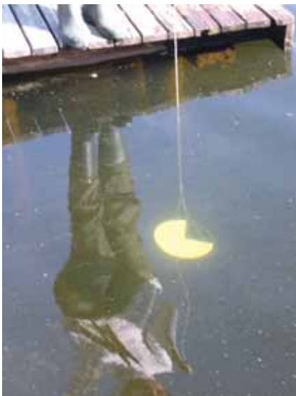
Sichttiefenmessung mit Secchi-Scheibe. Foto: M. Reichmann
